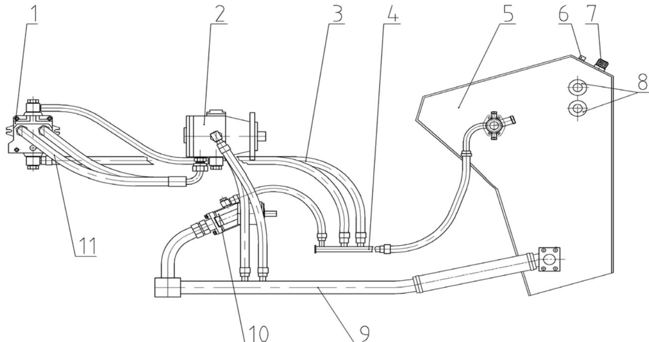
1 – гидромотор; 2 – насос; 3 – рукав низкого давления; 4 – трубопровод дренажный; 5 – гидробак; 6 – штуцер подсоединения рукава дренажа гидромолота; 7 – горловина заправочная; 8 – смотровые стёкла; 9 – трубопровод всасывающий; 10 – насос (рабочего оборудования); 11 – рукав высокого давления
