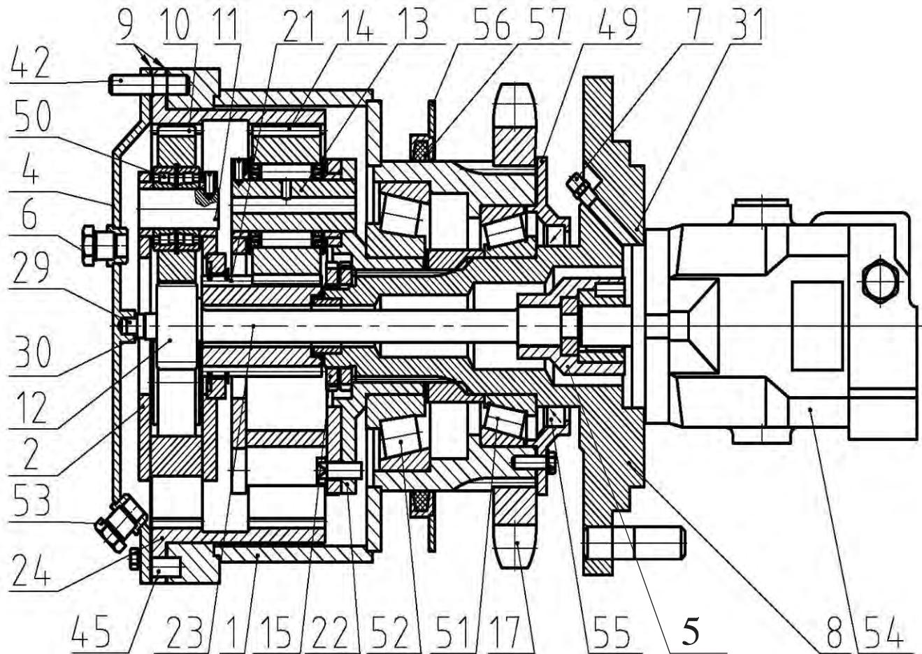
1 – ступица; 2, 22 – водила; 4, 49 – крышки; 5 – муфта; 6 – пробка контрольного отверстия; 7 – сапун; 8 – цапфа; 9, 31 – прокладки; 10, 14 – сателлиты; 11, 13 – оси; 12, 21 – шестерни; 15 – гайка; 17 – звёздочка; 23 – полуось; 24 – шестерня коронная; 29 – упор; 30 – прокладка; 42 – шпилька; 45 – штифт; 50, 51, 52, 57 – подшипники; 53 – пробка заливного отверстия; 54 – гидромотор; 55, 56 – манжеты
