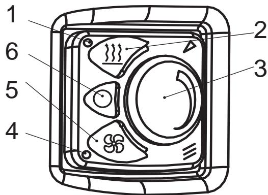
1 – контрольный сигнализатор работы отопителя; 2 – выключатель отопителя; 3 – регулятор температуры; 4 – контрольный сигнализатор включения вентилятора; 5 – выключатель вентилятора; 6 – выключатель режимов работы
