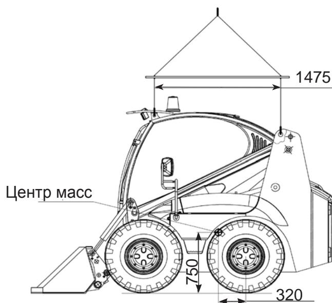
Рисунок 7.3 — Схема строповки
