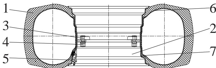
1 - покрышка; 2 - обод колеса; 3 - шпилька; 4 - гайка; 5 - вентиль камеры; 6 - камера; 7 - ободная лента
