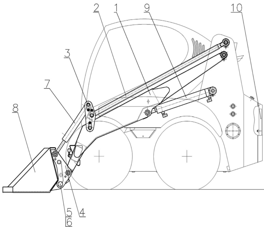
1 – стрела; 2 – тяга; 3 – рычаг; 4 – сцепка; 5 – гидроцилиндр сцепки; 6 – палец; 7 – гидроцилиндр поворота ковша; 8 – рабочий орган; 9 – гидроцилиндр подъёма стрелы; 10 – упор
