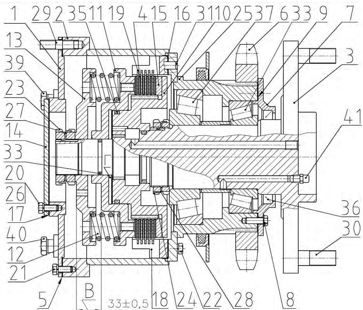
1, 7, 14 – крышки; 2, 10 – ступицы; 3 – цапфа; 4 – диск ведомый; 5, 9, 16, 17 – прокладки; 6 – звёздочка; 8 – планка стопорная; 11 – поршень; 12 – пружина; 13 – диск опорный; 15, 18 – диски; 19 – диск ведущий; 20, 21, 22 – болты; 23, 24 – гайки; 26, 27, 28 – шайбы; 29, 30 – шпильки; 31 – штифт; 32 – кольцо стопорное; 33, 34, 35 – кольца уплотнительные; 36 – манжета; 37, 38 – подшипники; 39, 40 – пробки; 41 – сапун
