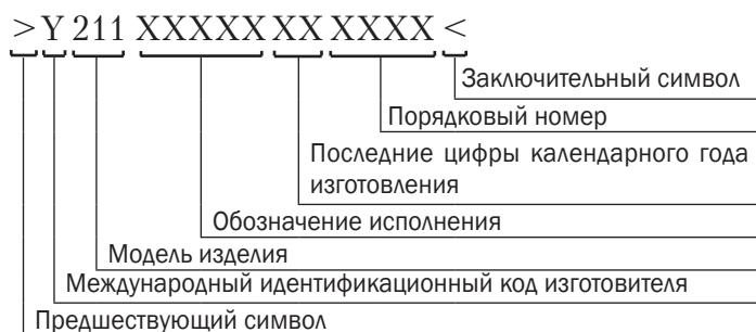
Рисунок 1.4 — Маркировочная табличка и её расшифровка
