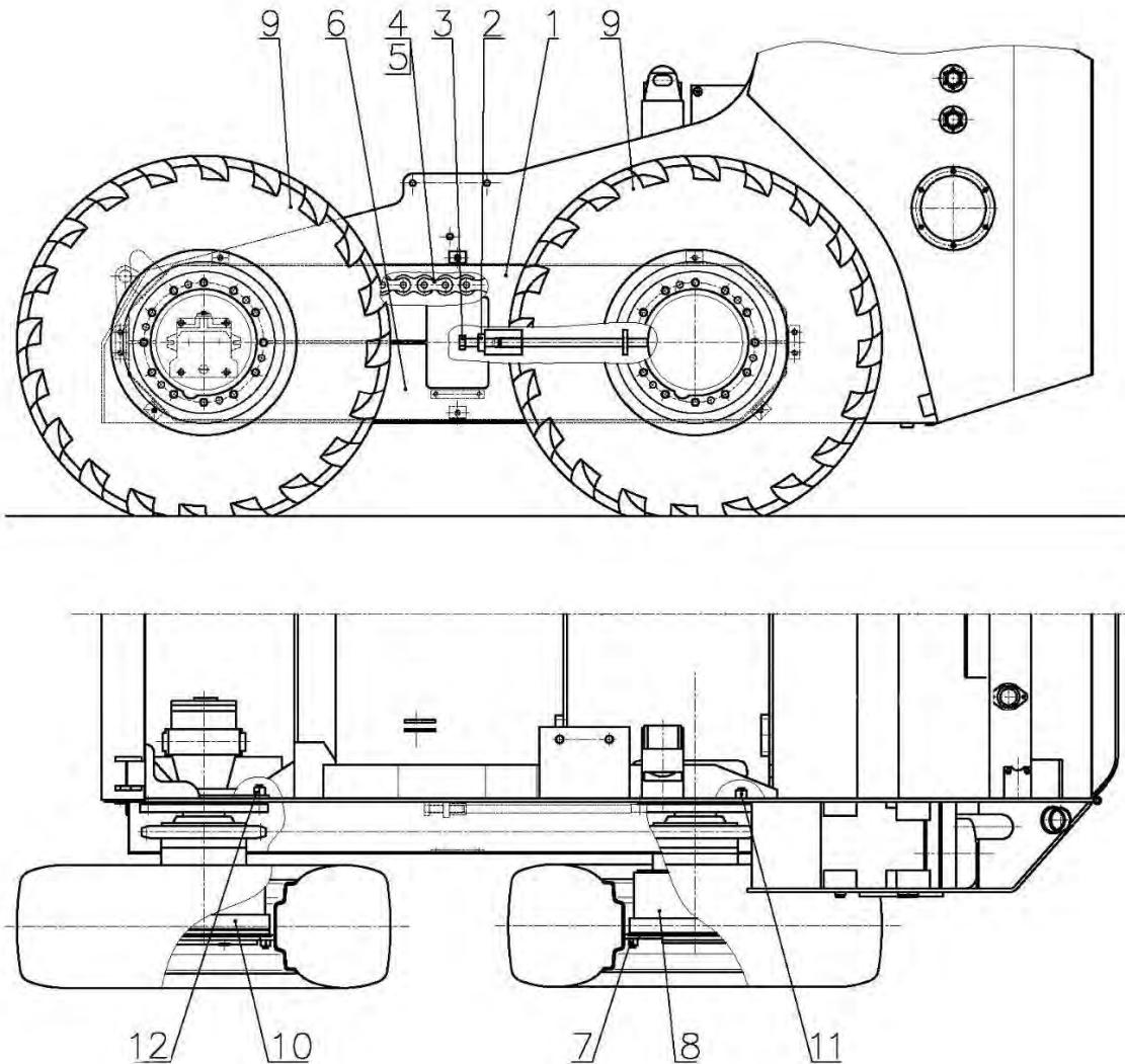
1 – кожух; 2 – контргайка; 3 – болт; 4 – цепь; 5 – звено; 6 – кожух; 7 – гайка; 8 – ступица с тормозом; 9 – колесо; 10 – редуктор колёсный; 11, 12 – гайки
