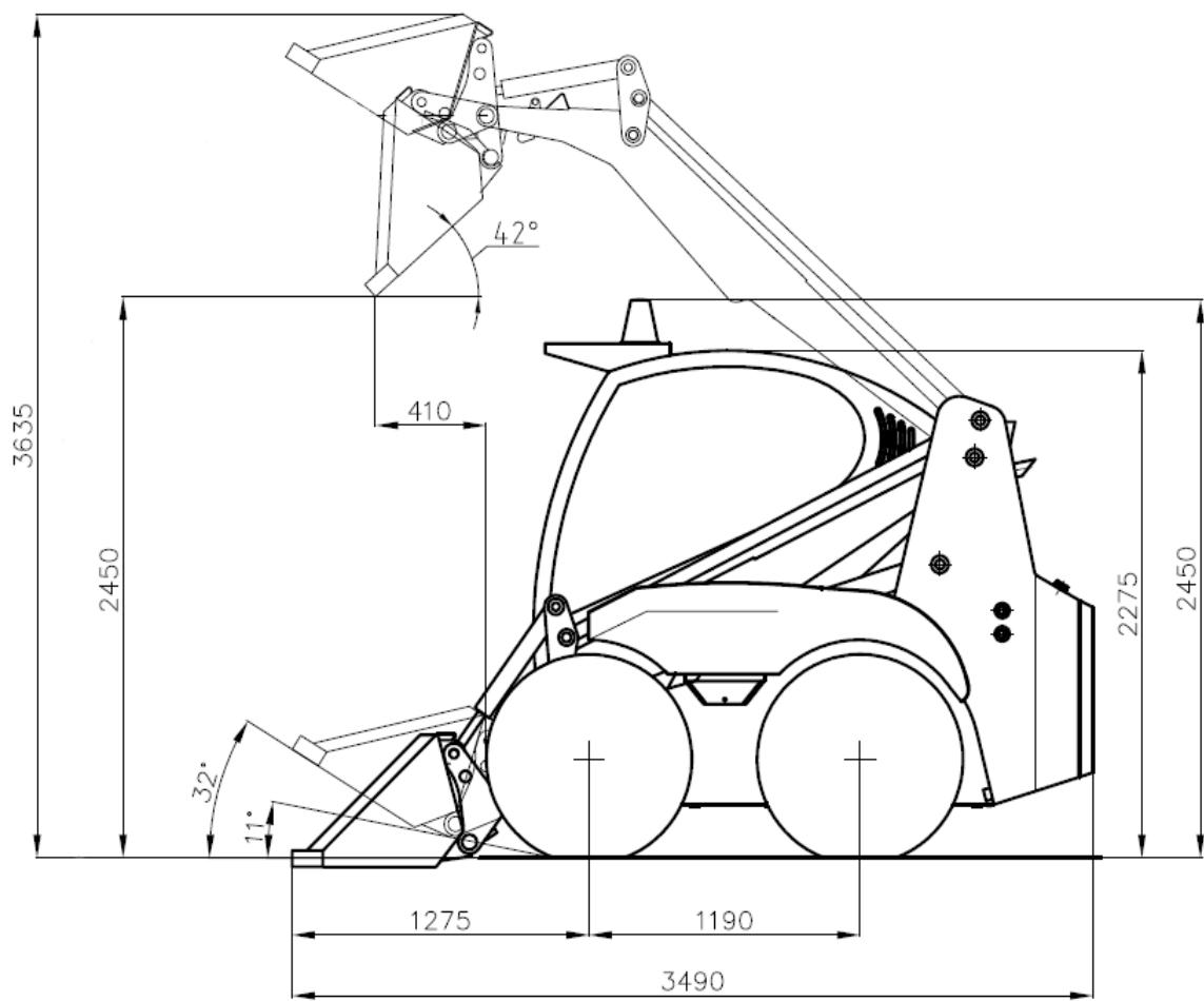
Рисунок 1.3 — Размерная схема погрузчика с основным ковшом
