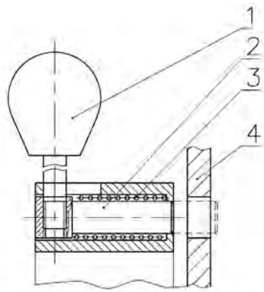
1 – рычаг; 2 – фиксатор; 3 – пружина; 4 – сцепка
