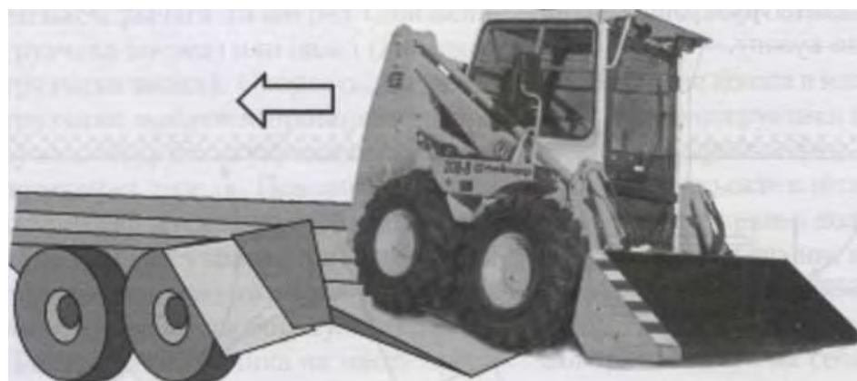
Рисунок 3.4 — Въезд погрузчика на трайлер своим ходом
