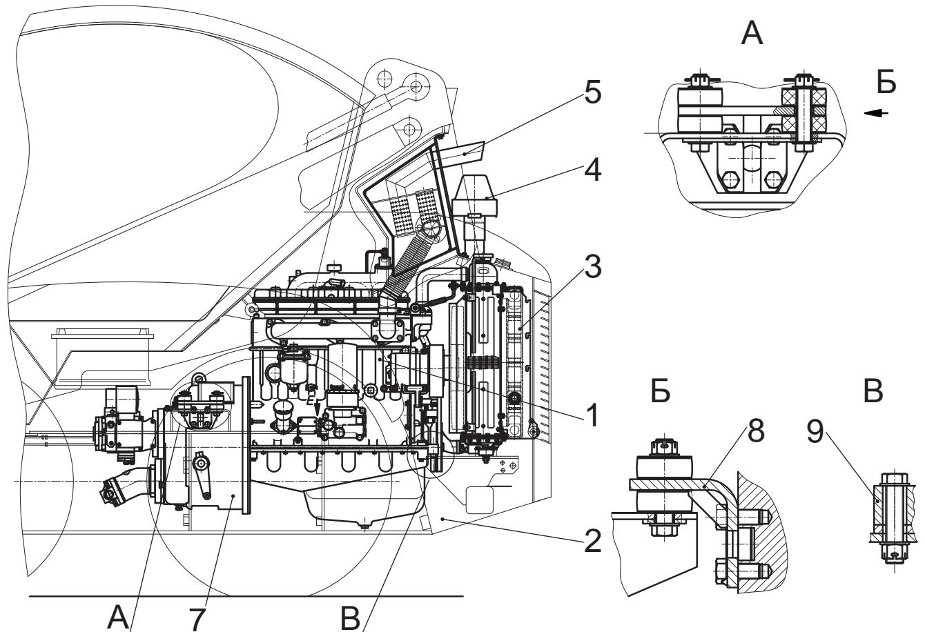
1 – дизель; 2 – система топливная; 3 – система охлаждения; 4 – воздухоочиститель; 5 – глушитель; 7 – редуктор привода насосов; 8,9- опоры
