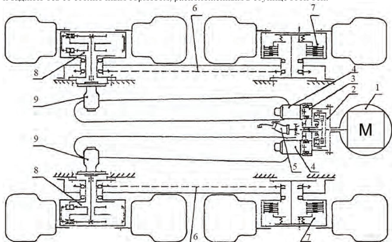
1 – дизель; 2 – диск ведомый; 3 – редуктор привода насосов; 4 – гидронасос; 5 – гидронасос привода рабочего оборудования; 6 – цепная передача; 7 – стояночный тормоз; 8 – редуктор колёсный; 9 – гидромотор привода хода
