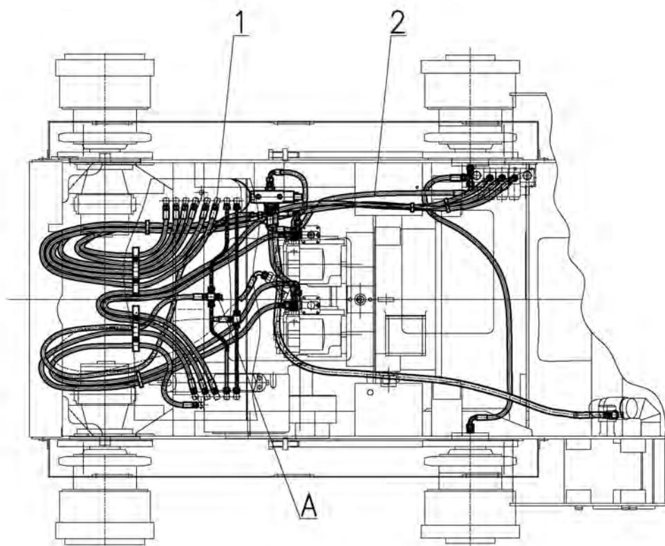
1 – блок питания НС-SE2; 2 – рукава высокого давления; А – отверстие для замера давления в гидросистеме управления
