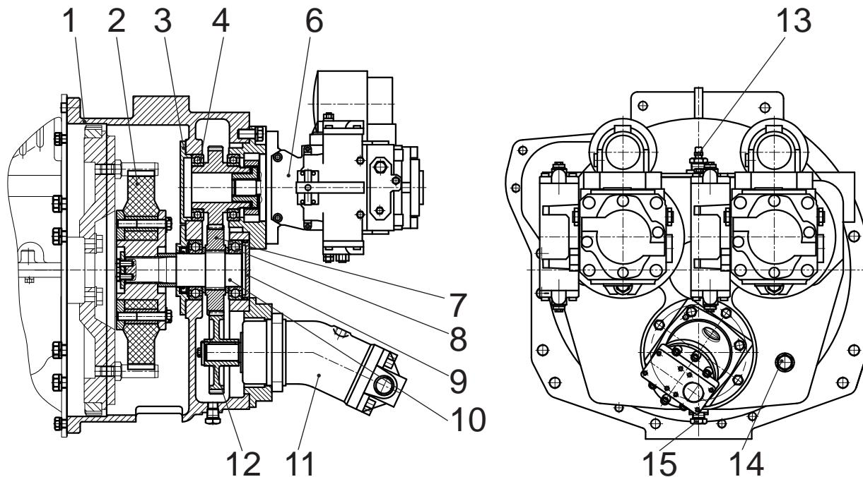
1 - корпус; 2 - диск ведомый; 3, 9 - крышки; 4, 8 - подшипники; 5 - шестерня; 6, 11 - насосы; 7, 12 - шестерни; 10 - вал; 13 - пробка-сапун; 14 - контрольная пробка; 15 - пробка сливная
