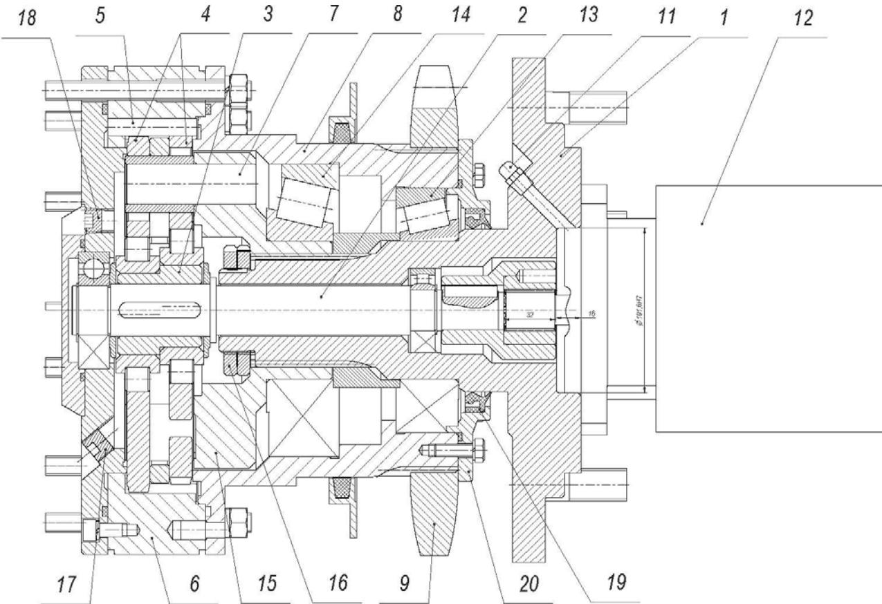
1 – цапфа, 2 – входной вал, 3 – эксцентрик, 4 – сателлиты, 5 – ось, 6 – обойма, 7 – палец, 8 – ступица, 9 – звёздочка, 11 – сапун, 13, 14 – подшипники, 15 – голова, 16 – гайка, 17 – пробка заливного отверстия, 18 – пробка контрольного отверстия, 19 – манжета, 20 – крышка
