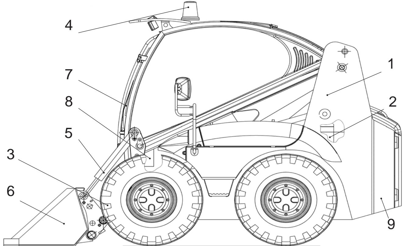
1 – рама; 2 – силовая установка; 3 – ходовая часть; 4 – электросистема; 5 – гидросистема; 6 – рабочее оборудование; 7 – кабина; 8 – система отопления и вентиляции; 9 – облицовка
