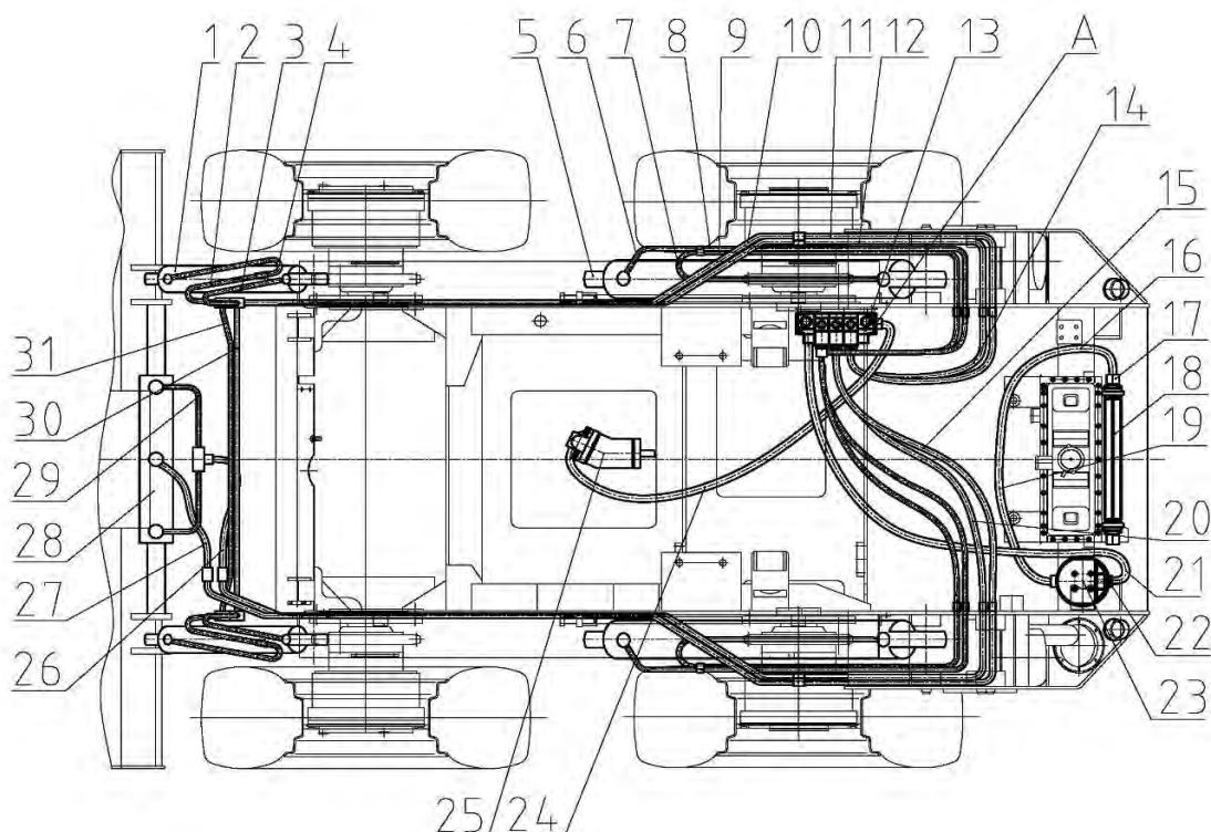
1 – гидроцилиндр ковша; 2, 3, 8, 9, 11, 12, 14, 15, 16, 19, 20, 21, 24, 26, 27 – рукава высокого давления; 4, 6, 7, 10, 14, 29, 30, 31 – трубопроводы; 5 – гидроцилиндры стрелы; 13 – гидрораспределитель; 17 – переходник; 18 – радиатор; 22 – штуцера; 23 – фильтр типа ФСК 32/3; 25 - насос типа 310.2.28; 28 – гидроцилиндр сцепки; А- отверстие для замера давления
