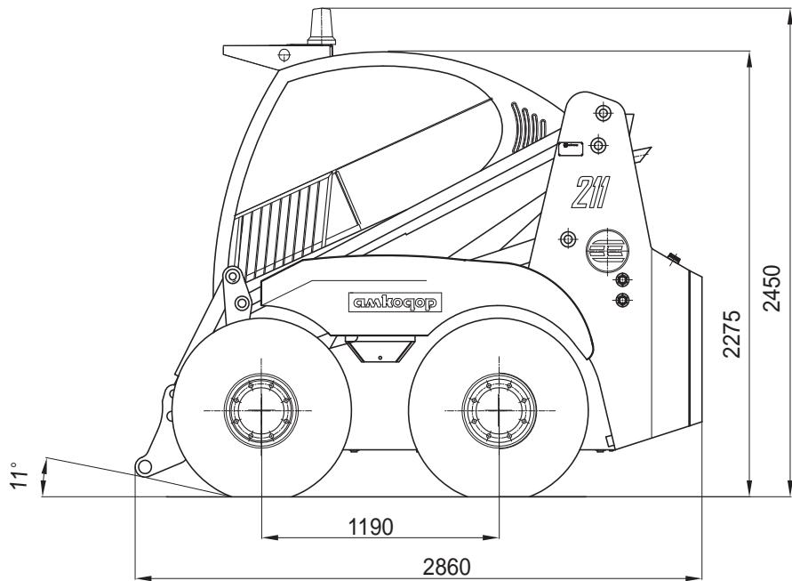
Рисунок 1.2 — Размерная схема машины
